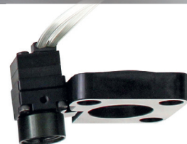
Módulo de cámara montado en el óptico para establecimiento y moni- toreo del proceso de soldado
