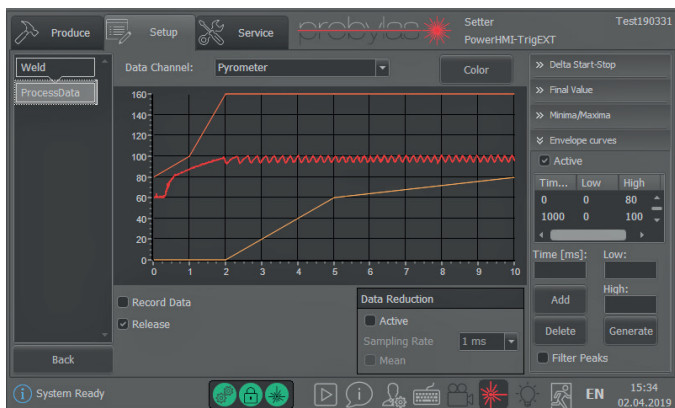
Selección y monitoreo de datos del proceso y funciones de análisis
