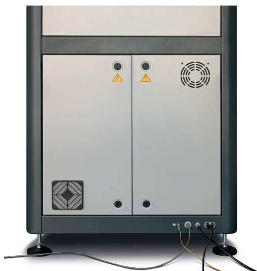
Gabinete eléctrico trasero del Turnkey M enfriado por aire y con dos puertas de ala. El suministro eléctrico y neumático está situado en la parte baja del gabinete eléctrico.
