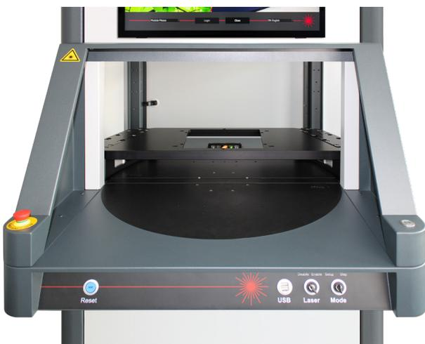
Grand plateau rotatif indexé avec large porte guillotine ouverte et unité de serrage à l'intérieur du plateau rotatif indexé.
