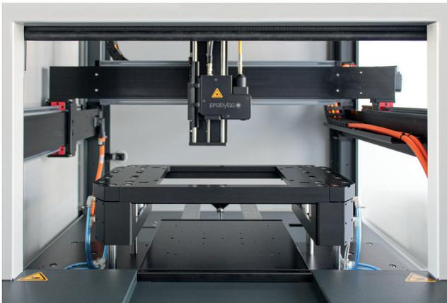
Superficie de soldado hasta un máximo de 500 x 400 mm con sistema de ejes que incluye un eje vertical Z y una unidad de sujeción extendida.
