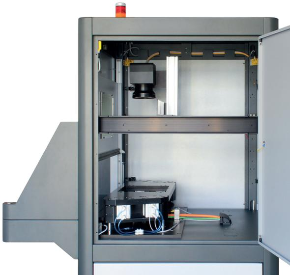
Acceso al área de soldado con unidad de sujeción, componentes ópticos, y sistema de movimiento a través de las puertas laterales.
