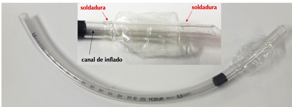
Ejemplo de una soldadura transparente con transparente entre un globo con un tubo de PVC para respiración artificial
