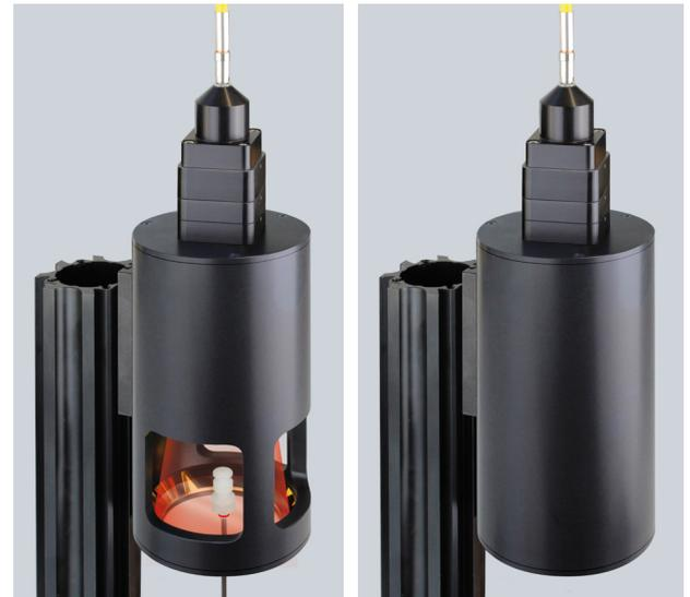
Versión abierta de óptico Radial mostrando el haz del láser.
